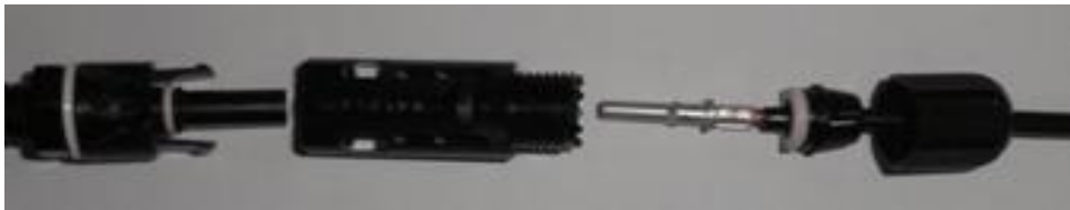
Fig 3-15 DC -케이블에 -커넥터 설치
