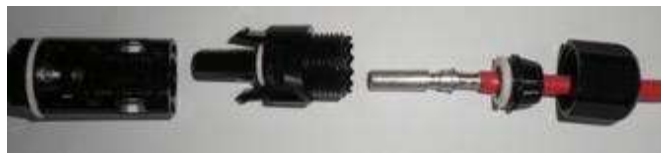
Fig 3-14 DC 양극 케이블에 양극 커넥터 설치
