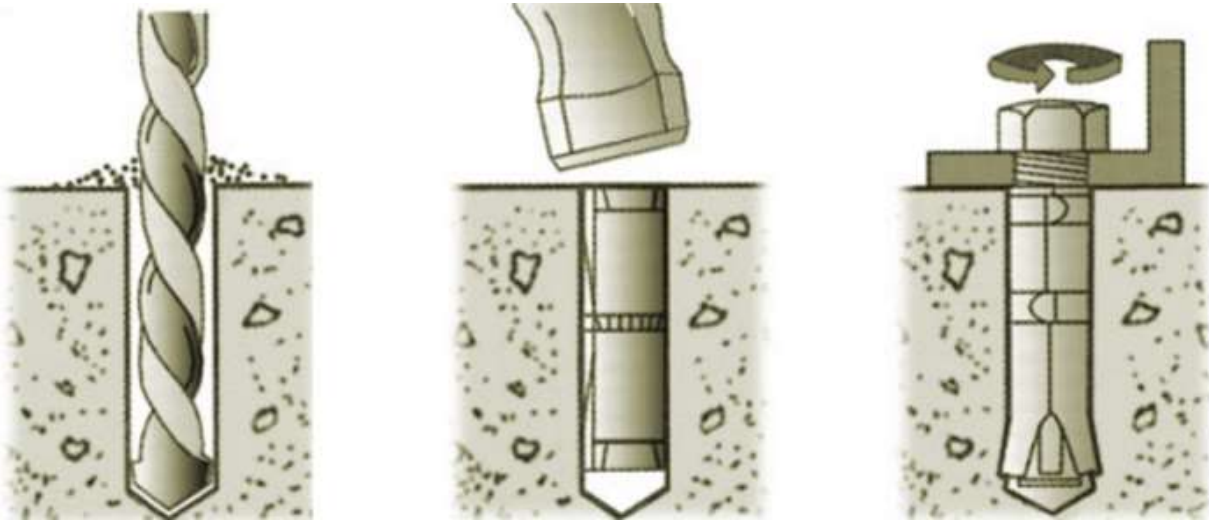
그림 4-5 드릴로 구멍을 뚫고 앵커 설정 및 조립 볼트를 조이십시오.
